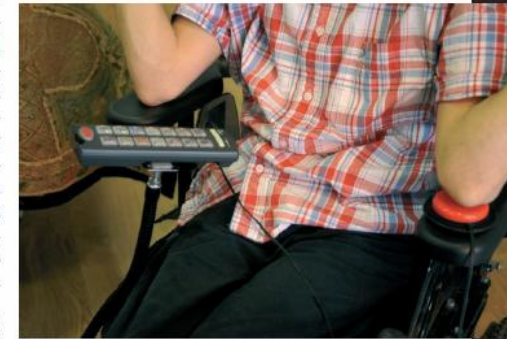
Acceso al ordenador con conmutador al mando a distancia.
